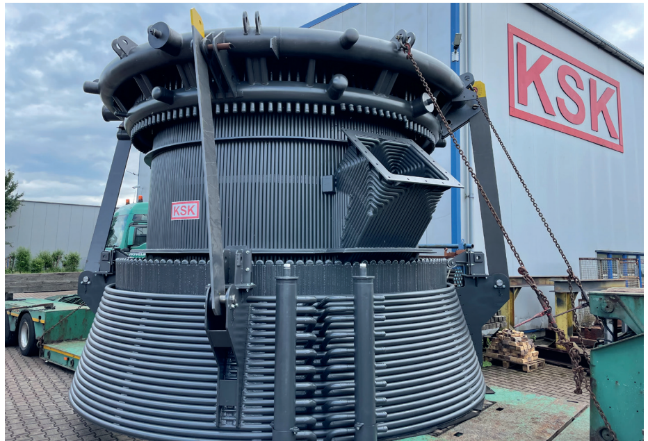
Im Abgaskamin von LD-Konvertern ist die Dampferzeugung in Kreisläufen mit Rohrkonstruktionen, wie dieser Konverterhaube mit Stelling, seit Jahrzehnten gängige Praxis
