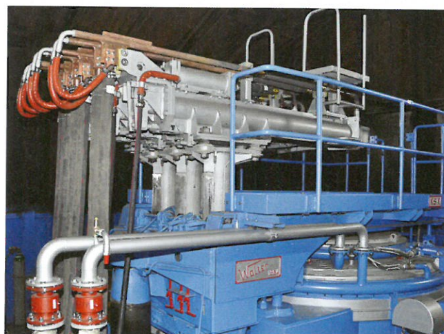
Bild 4: Der modifizierte LBO im April 2015, Darstellung der Elektrodentragarm- kühlung mit wasser- gekühlten Hoch- stromkabeln.
